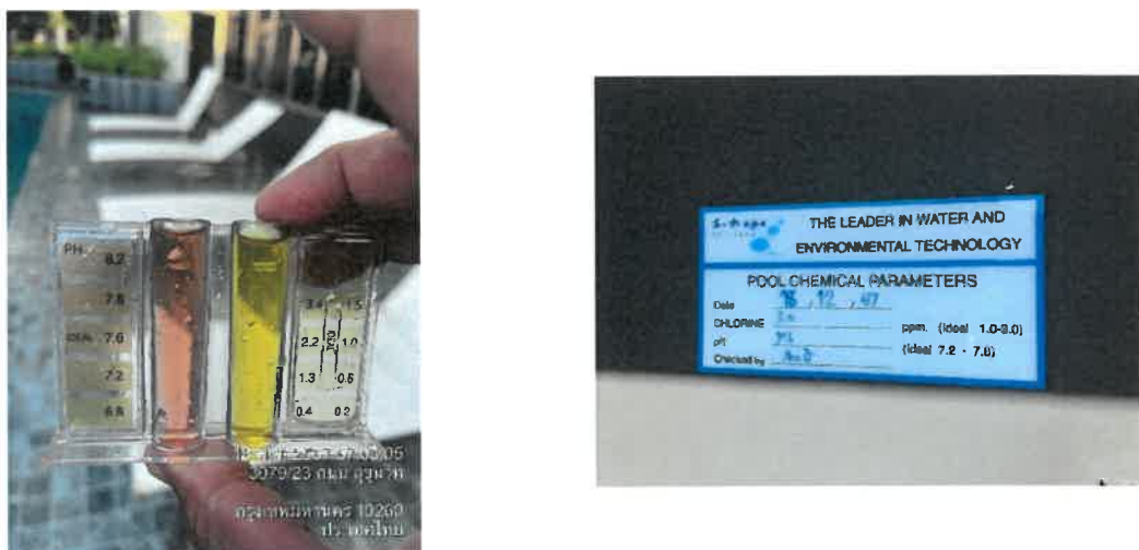
ภาพที่ 3.5.4-2 การตรวจวัด pH, \text{Cl}_2 สระว่ายน้ำ
